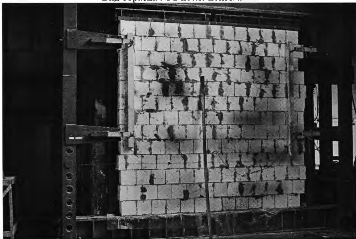
Вид образца № 1 после испытания
